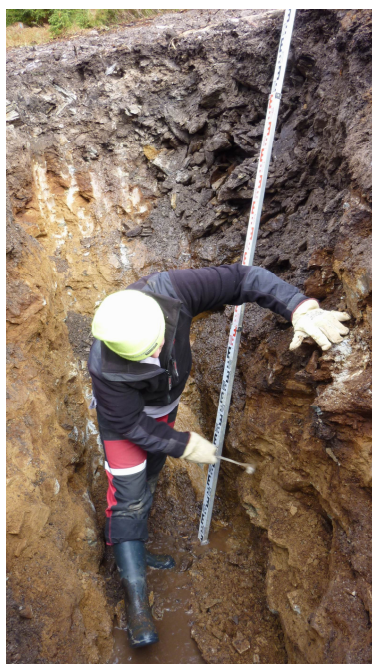
Geologická dokumentace byla prováděna přímým měřením vrstev ve výkopu (09/2013)
