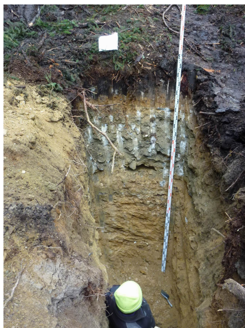
Geologická dokumentace byla prováděna přímým měřením vrstev ve výkopu (09/2013)
